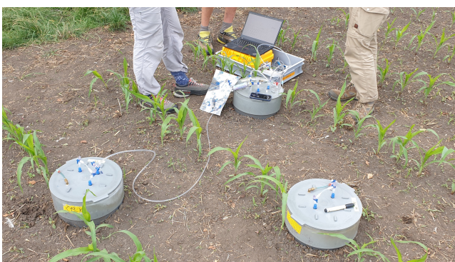
Abb. 4. Einsatz des LICOR Gerätes zur Gasbestimmung, sowie ein Beispiel einer Aufschüttung. Der darunter liegende Boden ist erkennbar an der dunklen Farbe.
